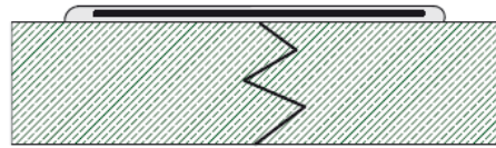
Agro Abdichtungsband 200/1, Riss abgeklebt
