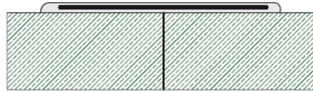
Agro Abdichtungsband 200/1, Stoßfuge abgeklebt
